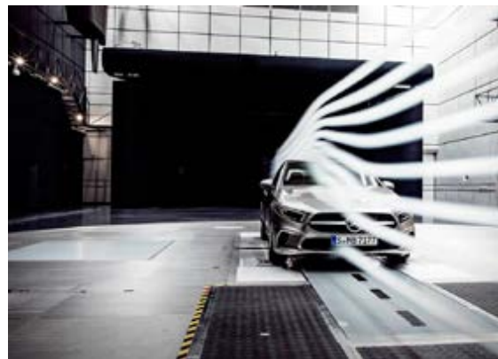
Mercedes Benz eyddi miklum tíma í vindgöngum til að ná niður vindstuðlinum.
