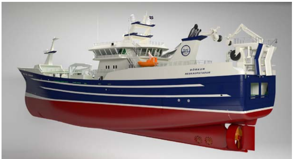
Hinn nýi Borkur verður smíðaður fyrir flotvörpu- og hringnótaveiðar. Lengd skipsins verður 88 metrar. MYND/ SVN
