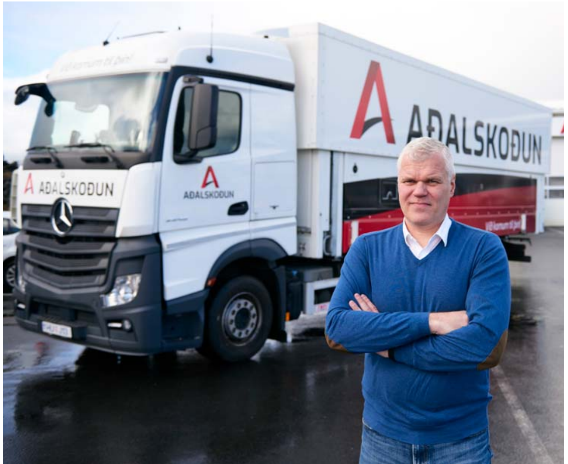
Ómar Pálmason við færanlegan skoðunarbil Aðalskoðunar sem er fullkomin stöð sem er fest ofan á Mercedes-Benz flutningabil sem flytur hana á milli staða.
