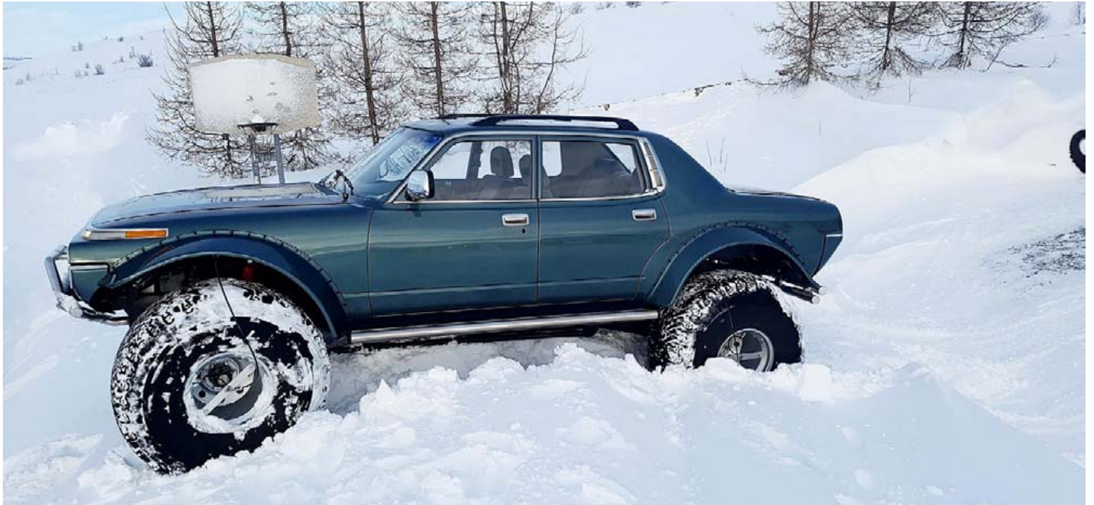
Billinn er með Toyota Crown 1972 boddi, undirvagn af Toyota Hilux, með 44 tommu dekk og innvols úr Toyota Camry.
