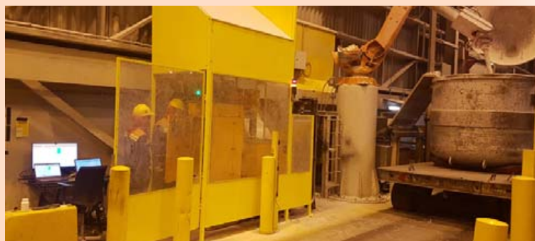
Búnaður DTE efnagreinin ál samstundis með ljósgeislataekni.
