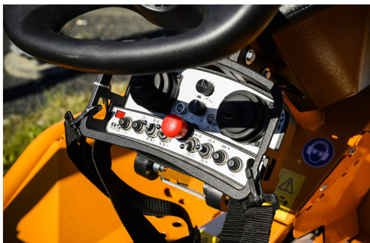
Hægt er að fá sláttutraktora með fjarstýringu, hún auðveldar vinnu í halla.
