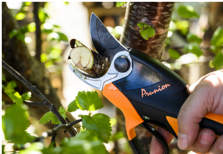
Pellenc Prunion greinaklippan klippir allt að 45 mm.
