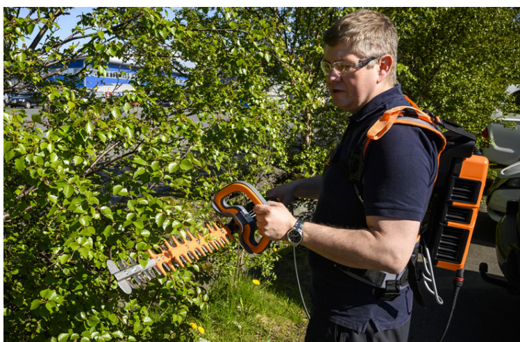
Rafhlöðudrifin hekkklippa með 33 mm klippigetu.
