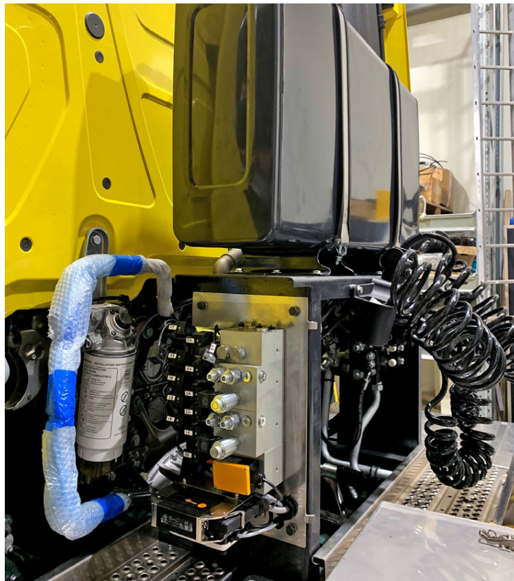
Hér má sjá vökva- og rafmagnskerfi fyrir vörubíla.
