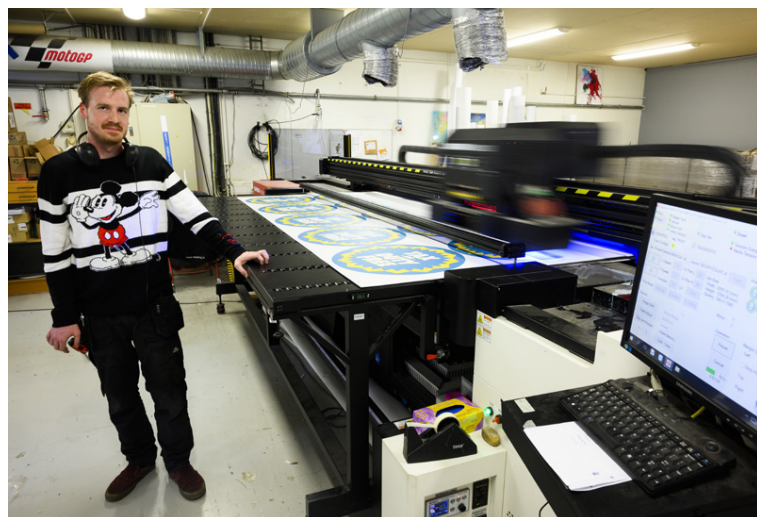
Í Merkingu er hægt að prenta á allt að fimm metra breiðan flöt í einu.
