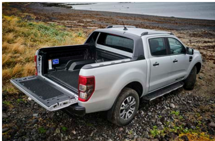
Pallurinn er klæddur og með festingum í gólfi og ber 1.081 kíló.
