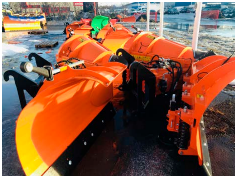
Það er hægt að festa þessar snjótennur á dráttarvélar til að ryðja snjó..
