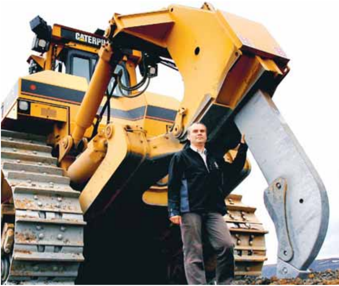
Aftan á jarðýtunni er öflug riftönn sem er notuð til að losa upp jarðveg. Hægt er að stilla lengd tannarinnar, en hún er lengst 180 cm löng. Þegar unnið er við erfiðar aðstæður má stytta tönnina og nær hún þá betur að losa um jarðveg.
