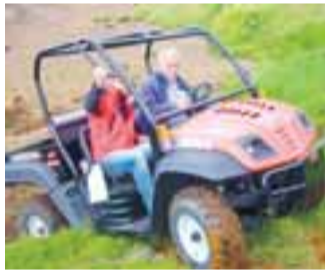
Bíllinn er fjórhjóladrifinn með hátt og lágt drif.
