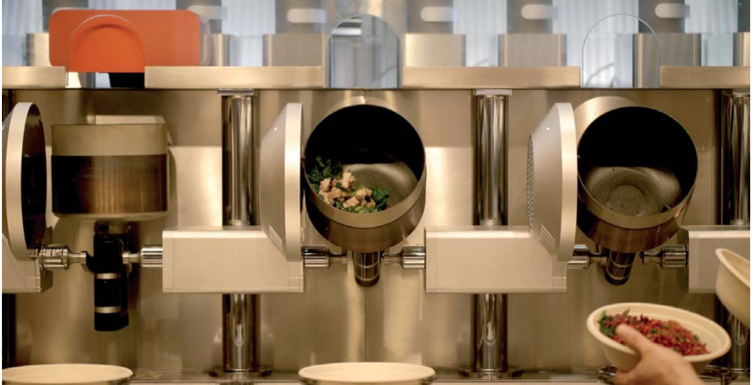
Maturinn er eldaður í litlum pottum sem eru hitaðir með segulkrafti. NORDICPHOTOS/GETTY
