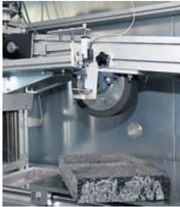
Notuð er vél sem líkir eftir akstri bíls á malbiksplatta til að kanna endingu malbiksins.
