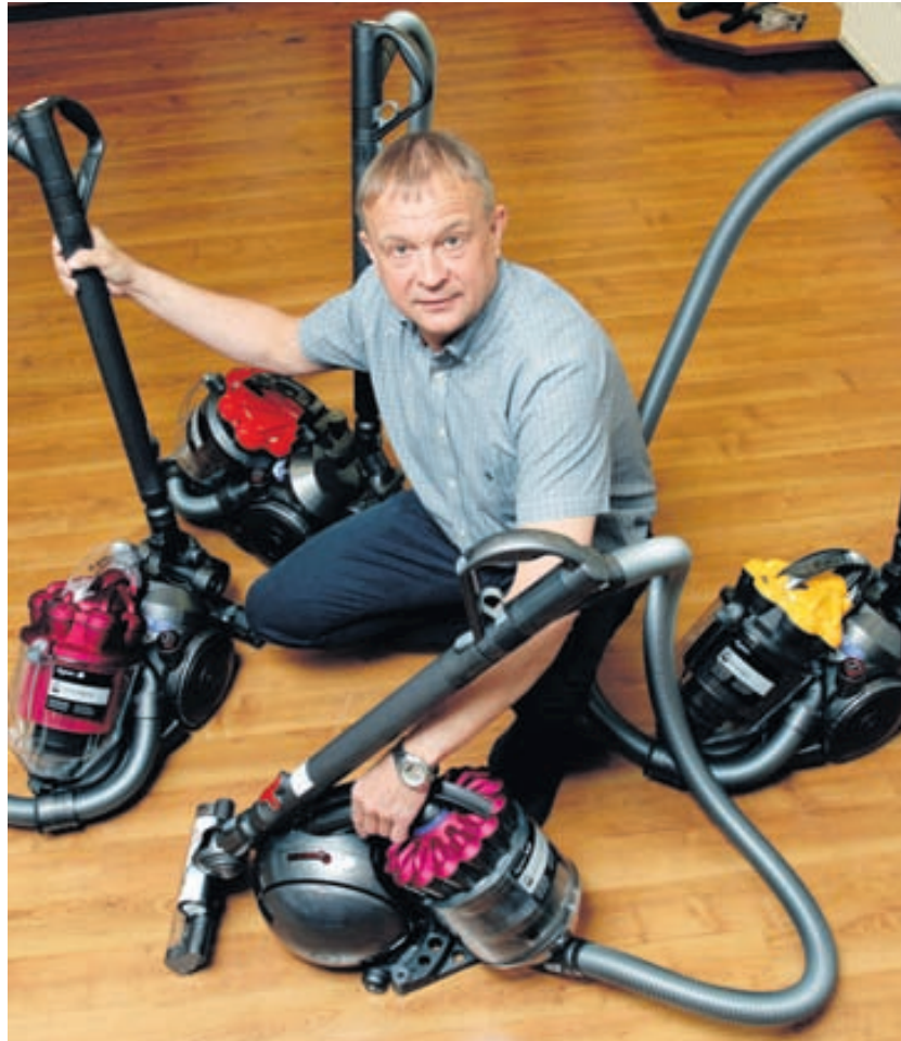
Ryksugurnar byggja á svokallaðri Root Cyclone tækni eða sílendum sem auka loftstreymið og skilja að óhreinindi sem safnast í ryksugutank og hreint loft sem ryksugan blæs frá sér. MYND/GVA
