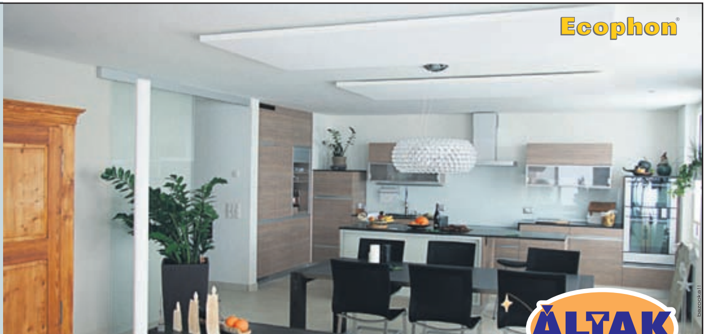
Ecophon Solo-plötur eru notaðar til að minnka glymjanda og hávaða. Þær eru settar upp með blindfestingum sem hleypa plötunni um 4 cm frá loftinu. Þessar plötur eru 1.200 x 2.400 mm.
