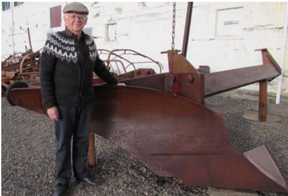
Bjarni Guðmundsson, prófessor við Landbúnaðarháskóla Íslands, stendur hér við skerpiplóginn sem naut mikilla vinsælda sem vinnutæki á jarðýtturnar við nýbrot mýra upp úr miðri síðustu öld.
