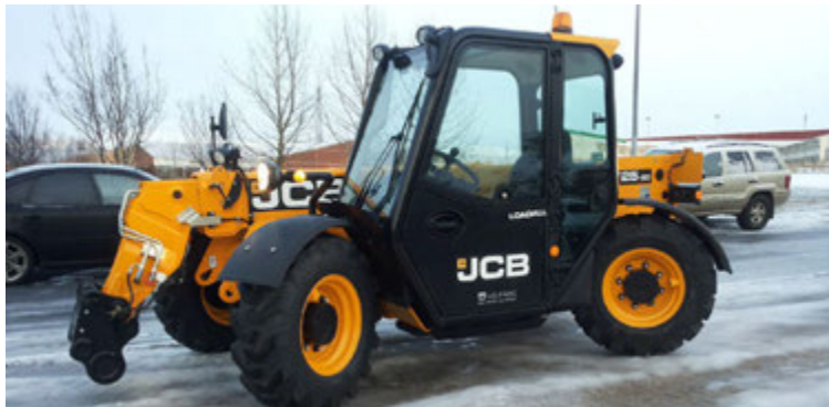
Vélfang kynnrir nýjan skotbómulyftara til leiks á þessu ári. Hér er um að ræða smáan en knáan lyftara sem er bara rúmlega 1,8 metrar á hæð og breidd og fer auðveldlega inn í gáma og getur lyft 2,5 tonnum í 6 metra hæð. Hann nær 40 kílómetra ökuhraða og er með fjaðrandi lyftigálga.
