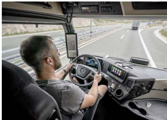
Nýr Actros er talsvert frábrugðinn fyrirrennara sínum. Í stað baksýnispegla eru nú tveir 15 tommu skjáir sem eru tengdir við myndavélar.
