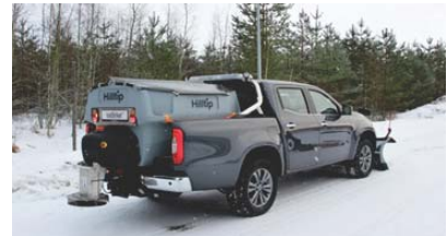
Hilltip rafdrifnir dreifarar fyrir pallbíla og minni vörubíla. 500-2600 lítrar.
