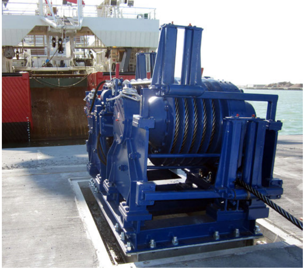
Taugin fer í gegnum vírastrekkítækið á hafnarbakkanum. Þetta leiðir til þess að togvírinn er undir stöðugu átaki í gegnum allt innsetningarferlið.
