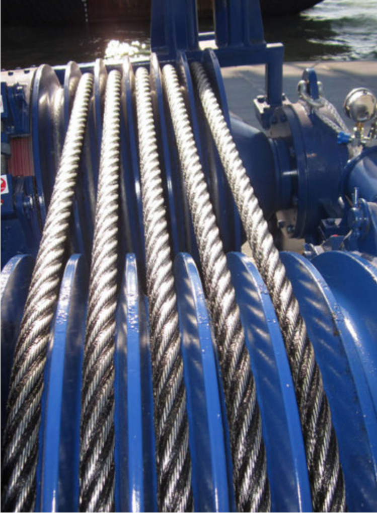
Þegar togvírnum er spólað fullkomlega undir stöðugu átaki er núningur í lágmarki þannig að togvírinn endist mun betur.
