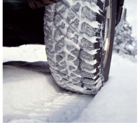
Vetrardekk eru með grófu mynstri til að þau gripi betur og renni ekki til.
