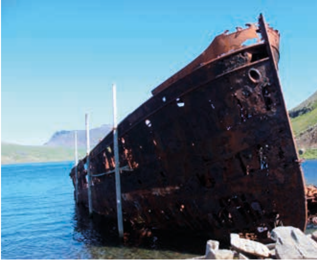
■ Skipið var smíðað á sínum tíma með sérstakri styrkingu til siglinga í lagnaðarís. Líkast til skýrir það hversu hægt tímans tönn vinnur á skrokknum.
