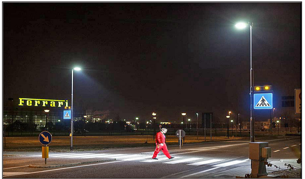
Nýr tæknibúnaður skynjar þegar gangandi vegfarendur nálgast gangbraut og kveikir þá LED götulýsingu. Þá kviknar einnig lýsing í gangbrautarkerkinu og viðvörðunarljós fyrir akandi umferð.
