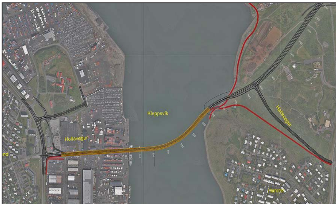
Sundabraut, gatnamót við Sæbraut og endar á stuttri landfyllingu við Gufunes. Sundabraut í rauðum lit.
