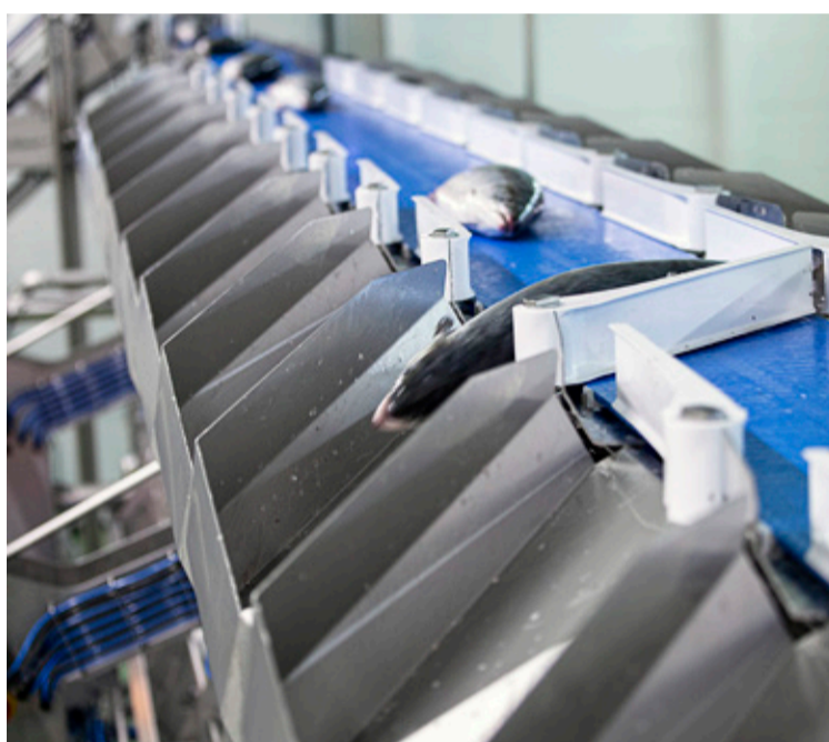
■ Í nýja Marel kerfinu hjá Búlandstindi er laxinn flokkaður í stærðir áður en hann fer í þökkun.
