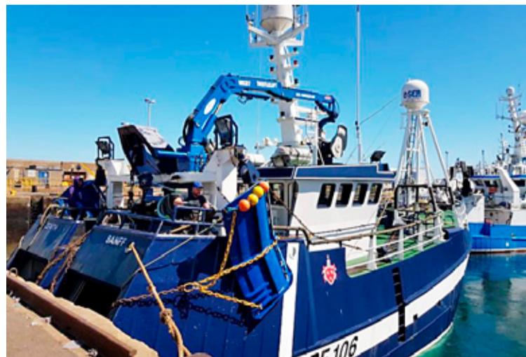
■ Til að fá hlera til að vera stöðugri í sjó hafa menn brugðið á ýmis ráð. Hér má sjá dæmi af erlendum togbát þar sem búið er að festa flotkúlur efst á hlerana til að búa til uppdrift. Flotkúlurnar taka hins vegar á sig mikinn sjó, gera hlerana óstöðuga auk þess sem mótstaðan eykst mikið og þar með olíueyðsla.
