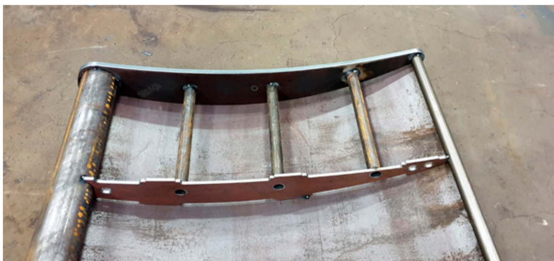
■ Hér sjást loftlásrörin í Ekkó hlera sem er í smíðum. Loftrýmið er því inni í hleranum og veldur engri mótstöðu þegar hann er dreginn
