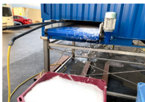
Ísgámur með ísvél, færibaldi og stýringum smíðaður fyrir fiskvinnslu í Grænlandi.
