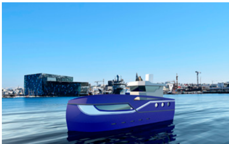
■ Rafmagnsbáturinn sem Navis hefur lokið hönnun á. Rafhlöðurnar eru í kili hans og nýtast um leið sem ballest.
