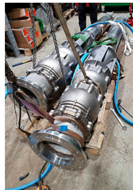
■ Tvær borholudælur 45kW og 130kW.
