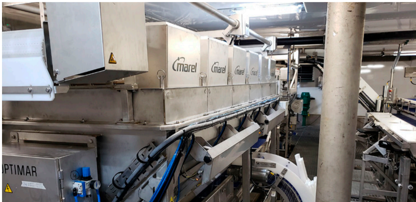
■ Búnaður frá Marel gerir kleift að flokka afurðir í vinnsluferlinu.
