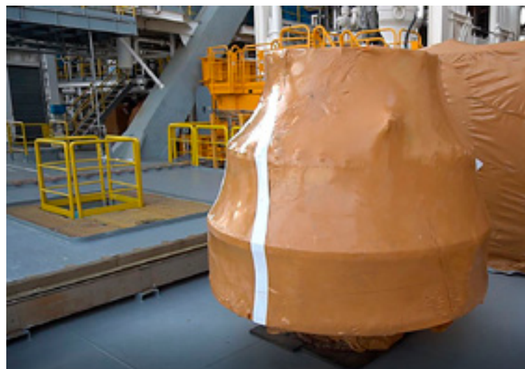
■ Vélbúnaður tilbúinn til geymslu í lengri tíma. Hér er búið að verja búnaðinn með þar til gerðum efnum frá Cortec og pakka inn í plast.
