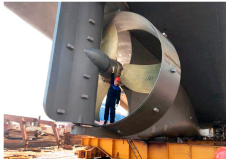
■ Systurskipin Breki VE og Páll Pálsson ÍS eru hönnun frá Skipasýn og þau eru búin skrófum sem eru fimm metrar í þvermál. Hér er Breki VE í smíðum.
