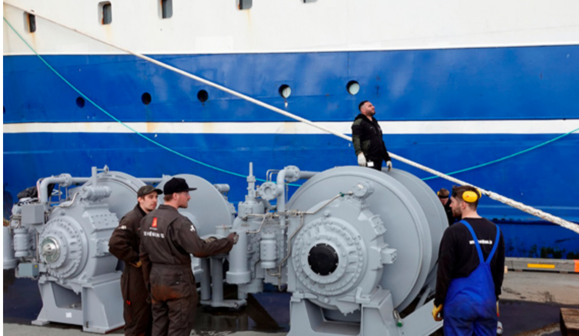
■ Starfsmenn skipa- og véladeildar Héðins undirbúa uppsetningu á nýjum Kongsberg togspilum um borð í Tómasi Þorvaldssyni GK.
