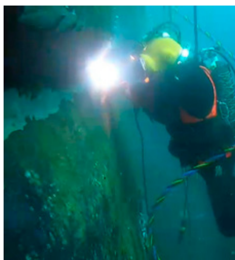
■ Lagfæra þurft skemmdir á prammanum neðansjávar og þetta hann til að hægt væri að fleyta honum á ný.
